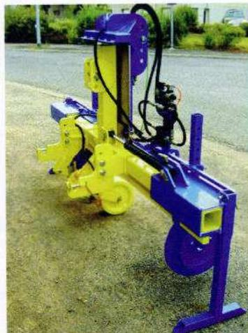
✓ D'un second bâti, mobile par rapport au premier, coulissant dans deux carrés munis de téflon et commandé par un vérin hydraulique qui reçoit les ordres de déplacement par les cellules photoélectriques (partie jaune).
