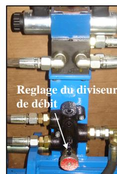
5. Si vous êtes **équipé d'un tracteur avec une pompe à débit variable** (genre JOHN DEERE), vous ne devez plus passer par le diviseur de débit. Pour cela vos flexibles pression et retour doivent être branchés directement sur le distributeur électro-hydraulique (coude) (pression en P retour en T).
